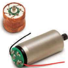
コアレスモータのロングライフ化対応とノイズ対策
