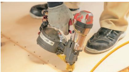
釘打ち機は、電動で釘打ちを行う工具です。
