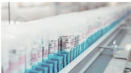
検体検査搬送システムは、採取した検体に必要な処理（遠心分離、検体分注など）を行い、該当する分析機へ自動投入します。
