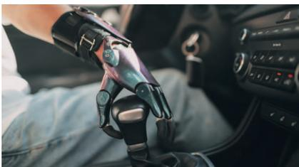
筋電義手は、筋肉に発生する表面筋電位の出力量によって動作制御される義手です。
