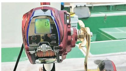
電動リールは、自動で釣り糸の投下、巻き上げを行う船釣り用の釣り具です。当社モータは、釣り糸の巻取りを電動、手動に切り替えるクラッチ機構に使用されています。
