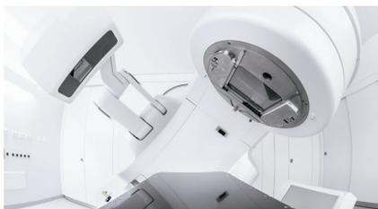
放射線治療機は、がん細胞へ効率的に放射線を照射します。当社モータは、患部周囲の正常な組織を保護するため、患部のみへ放射線を照射する微細な照準調節を行う駆動機構に使用されています。
