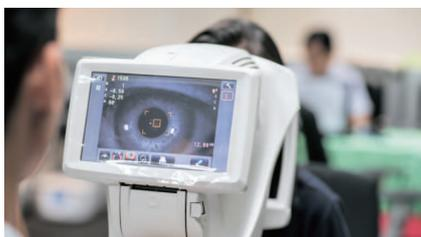
オートレフ (ケラト/ラクト) メーターは、自動で遠視・乱視・近視の程度、角膜のカーブを測定を行います。当社モータは、被検眼の測定に適した位置へレンズを調整する X、Y、Z 軸の移動機構に使用されています。
