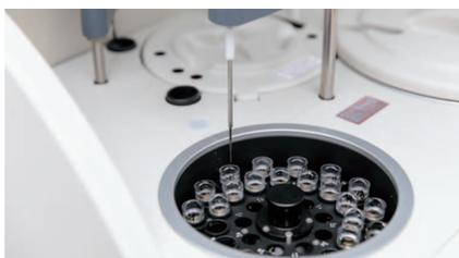
生化学自動分析装置は、血液、尿などの体液成分に含有している糖、コレステロール、タンパク、酵素等の各種成分を測定します。当社モータは、試験管に貼付したバーコードの読み取り機構に使用されています。
